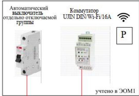
Вводный распределительный электрощит(квартирный)
