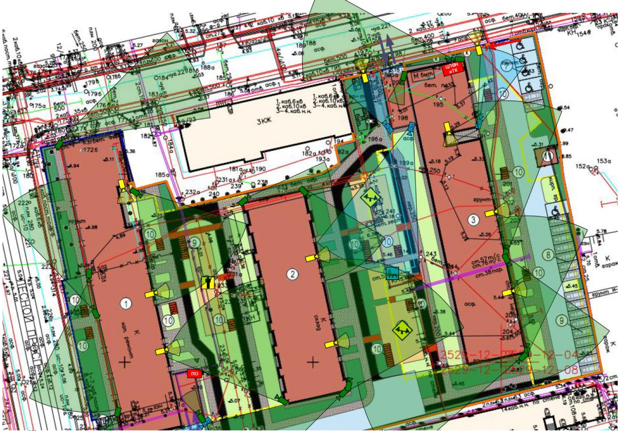
Схема расположения и зоны покрытия камер видеонаблюдения на территории жилого комплекса.
