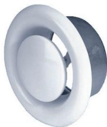
Регулирование расхода воздуха производится поворотом штока диффузора. Измерение расхода воздуха осуществляется измерением разницы давления при помощи специальной измерительной трубки.
