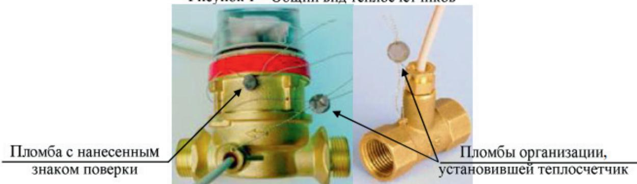
Рисунок 2 – Схема пломбировки теплосчетчиков
